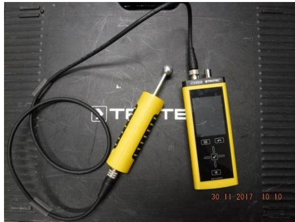
Trotec T3000 monitoimilaitte ja TS 660 SDI – materiaalikosteusanturi
