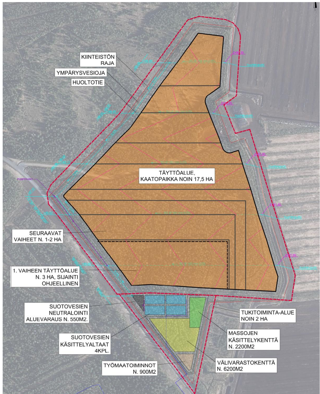
Kuva 2. Loppusijoitusalueen rakentamisen vaiheet ja toimintojen sijoittuminen kaatopaikka-alueelle.
